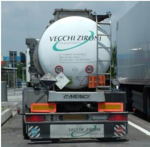
Caratteristiche tecniche: Sezione cilindrica (quasi sempre) in acciaio inox La cisterna è di dimensioni ridotte a causa del maggiore peso specifico della sostanza
